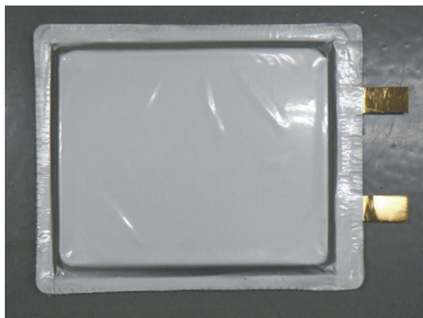
図8 フローレスラミネートセル外観 Fig.8 Laminated flow-less vanadium redox cell
