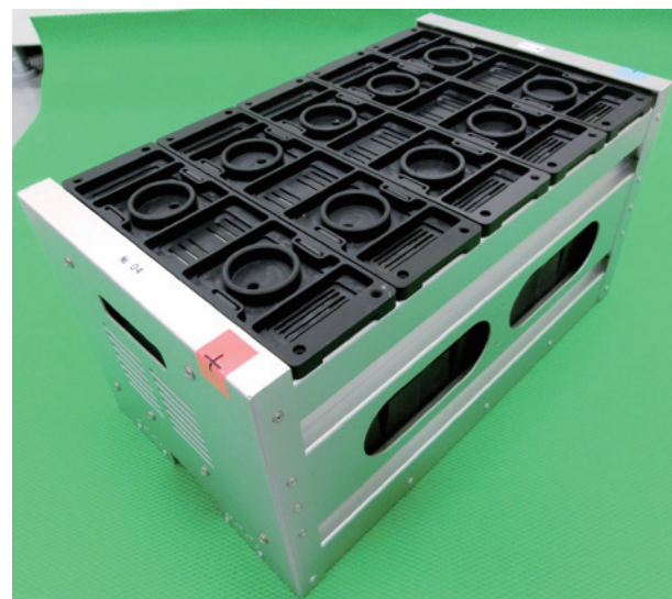
図3 Mgモジュール Fig.3 Mg cell module
