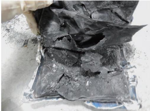
図5 過充電限界試験後のコートセパレータNCM-Graphiteセル内部
