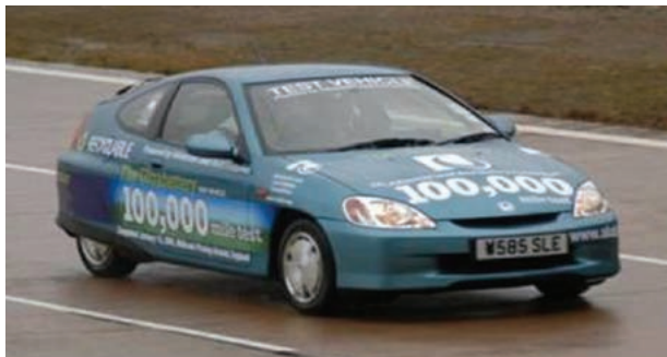
図5 フィールド実車試験にて100,000マイル(約160,000km) 達成したプロトタイプウルトラバッテリー搭載ホンダインサイト HEV Fig.5 Honda-Insight HEV equipped with 144V UltraBattery pack achieved 100,000 miles driving (160,000km) in field test
