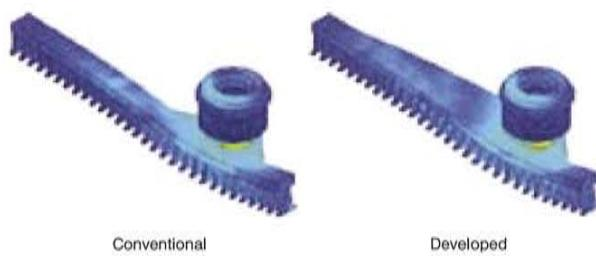
図 7 ストラップ応力分布比較
