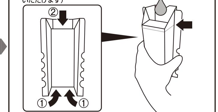
4 じょうごの先端を注水口に差し込み、注水カップの中の水を全て注入します。
