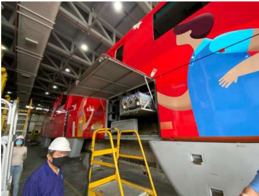
シンガポールのセントーサ・エクスプレスに搭載される古河電池のアルカリ蓄電池
