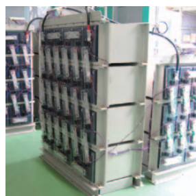
FCP1000 × 156S 電池をラックに収納して、モジュール化
