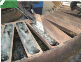
使用済バッテリーから取り出した中身は精錬後、バッテリーの原料として使えるよう、一定の形に流し込んで冷却し、インゴット状にします。
