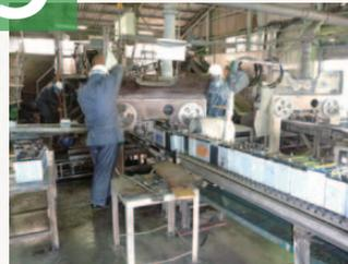
再資源化委託先では、使用済バッテリーの外装ケースを切断し、中身を取り出す作業を行います。
