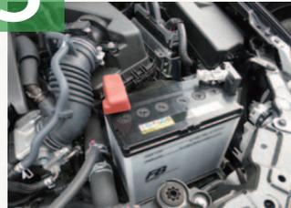
バッテリーは、自動車の稼働に欠かせない電気の供給源です。
