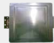
2023 宇宙用ステンラミネート型 リチウムイオン電池を開発し、 小型月着陸実証機「SLIM」に搭載
