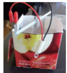
▲製作したマグネシウム空気電池
