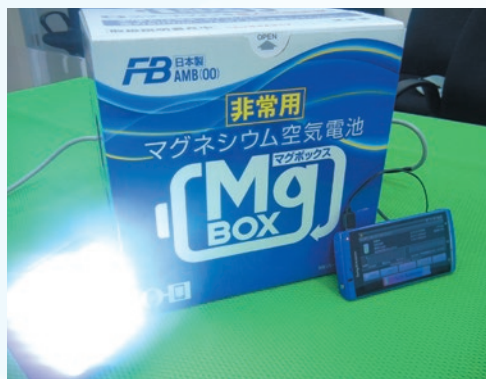
Mg-BOXで、スマートフォンの充電とLEDライトの点灯を同時に行っている様子
